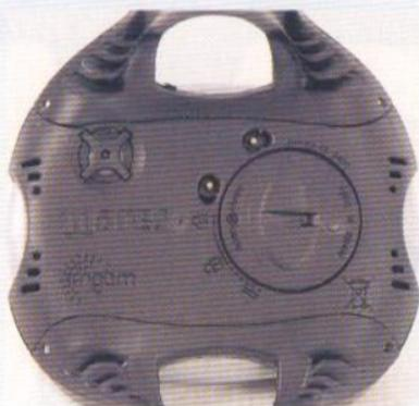
Einfacher kann ein Batteriewechsel kaum sein. Mit einem Geldstück den Deckel (siehe Bild) abschrauben und die Batterie wechseln. Reinigen Sie den O-Ring und tauschen Sie ihn bei einer leichten Beschädigung oder Verformung aus. O-Ringe gibt es als Ersatzteil bei jedem Mares-Händler. Wer auf Nummer sicher gehen möchte, lässt den Austausch von seinem Tauchsport Händler vornehmen.
