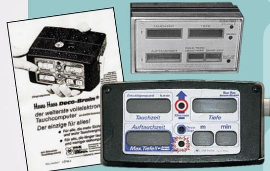
Der erste vollwertige Dekompressionscomputer – der Deco Brain – zeigt sowohl die Dekompressionsstufen als auch die gesamte Austauschzeit an
