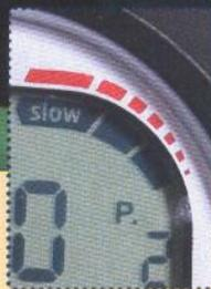
Die Skala für die Aufstiegsgeschwindigkeit liegt etwas »versteckt«
