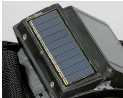
Über ein kleines Solar-Panel wird der Rechner auch bei wenig Licht immer wieder aufgeladen. Zwei Stunden Licht bedeuten circa eine Stunde tauchen. Zusätzlich kann der „SDA“ aber auch über einen USB-Anschluss oder dem optionalen Ladegerät aufgeladen werden.
