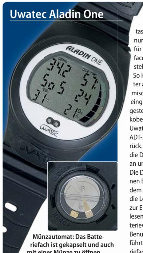
Münzautomat: Das Batteriefach ist gekapselt und auch mit einer Münze zu öffnen
