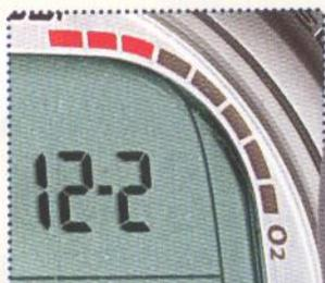
Die Aufsättigung mit Stickstoff und / oder Sauerstoff wird bei vielen Modellen in einer Skala angezeigt
