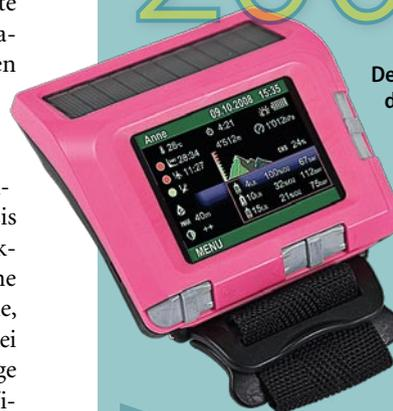
Der uemis Zurich ist der erste Tauchcomputer, der mit einer farbigen OLED-Anzeige und einem Solar-Modul zum selbstständigen Laden des Akkus ausgestattet wurde.
