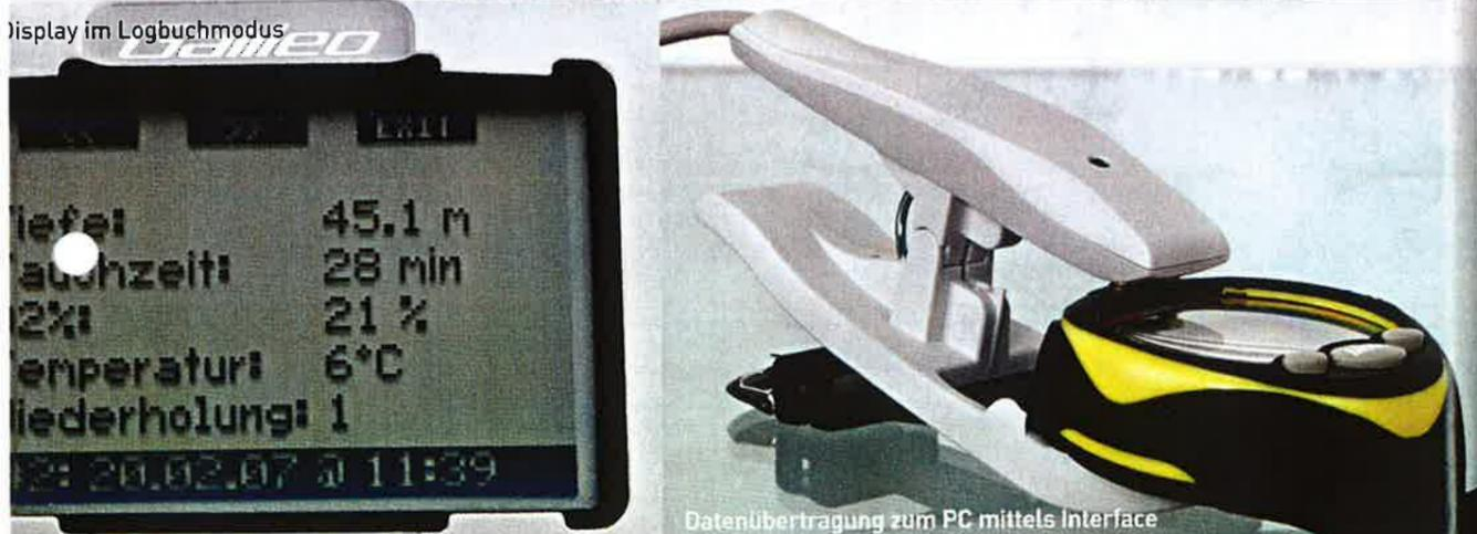
Display im Logbuchmodus      Datenübertragung zum PC mittels Interface
