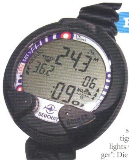
Nitrox bis 50 Prozent, Tiefenmesser-Modus und eine einstellbare Beleuchtung (fünf oder zehn Sekunden) sind die wichtigsten Highlights vom „Voyager“. Die Bedienung erfolgt recht einfach über
