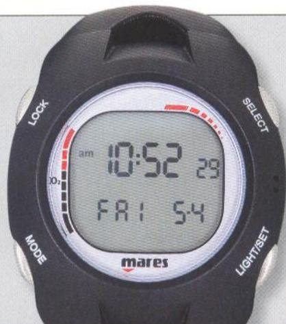
Der Mares Nemo wurde auf Diät gesetzt – heraus kam eine ansehnliche Sportversion. Im Uhrmodus bietet er neben der Weck- und Alarmfunktion zwei Zeitzonen inklusive Kalender. Im Tauchgangsmodus greift der 349-Euro-Rechner auf das bewährte RGB-Modell zurück und ermöglicht auch das Abtauchen mit Nitrox (bis zu 99% O<sub>2</sub>-Anteil). Ist die Batterie leer, darf sie nur vom autorisierten Service getauscht werden.
