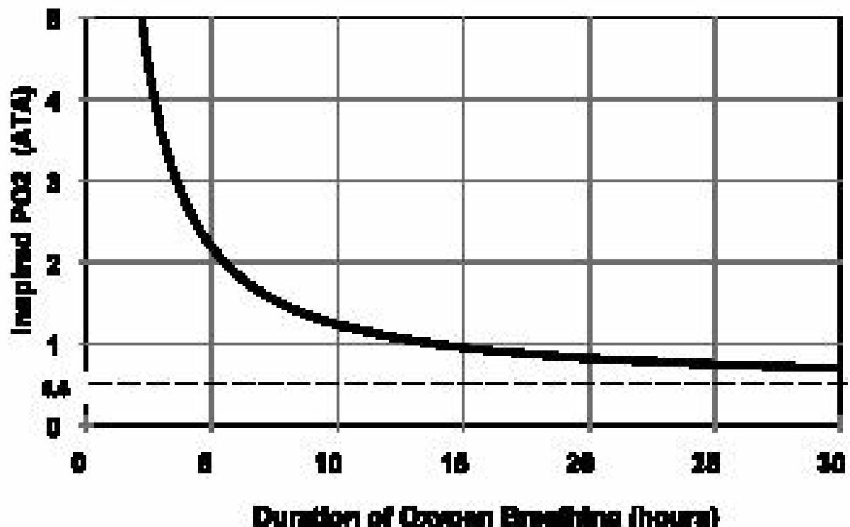
$$\text{OTU} = t * ((\text{pO}_2 - 0,5) / 0,5) \exp 0,83$$
